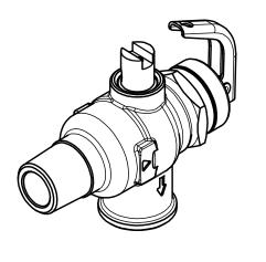
**2** FIT 2 PIECES OF EXPANSION VALVE INSULATION AROUND VALVE
